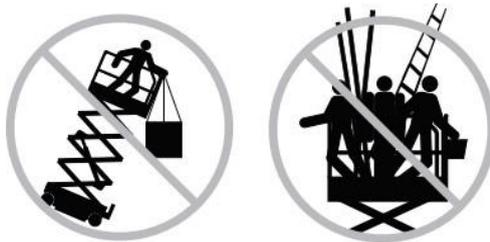
Não coloque ou prenda cargas fixas ou suspensas em qualquer parte desta máquina.
