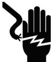
Conecte o carregador da bateria apenas a uma tomada de 3 fios aterrada.
