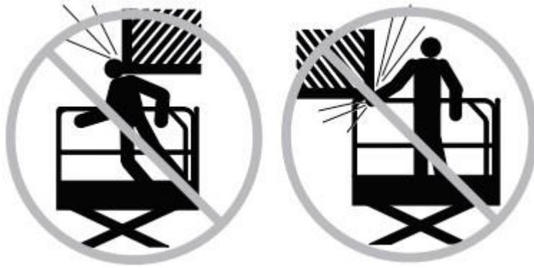
Esteja ciente do risco de esmagamento ao segurar o corrimão de proteção da plataforma. Observe e use as setas de direção codificadas por cores nos controles e na placa de decalque da plataforma para as funções de movimento e direção.
