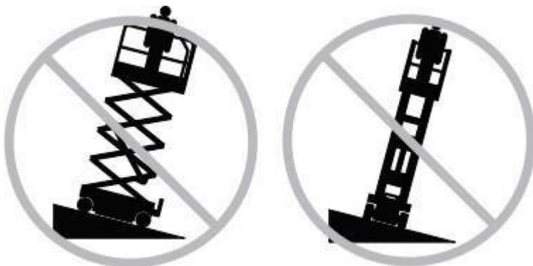
Não dependa do alarme de inclinação como um indicador de nível. O alarme de inclinação soa apenas na plataforma quando a máquina estiver em um declive.
