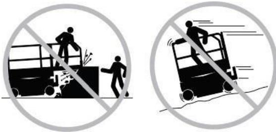
Limite a velocidade de deslocamento de acordo com a condição da superfície do solo, congestionamento, inclinação, localização da equipe e quaisquer outros fatores que possam causar colisão.
