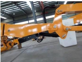
O cilindro nivelador da plataforma garante que a ela permaneça nivelada durante toda a amplitude de movimento da lança. A plataforma permanece nivelada em relação à mesa rotativa.
