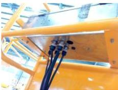
4. Desconecte o cabo existente na parte inferior da caixa de controle.
